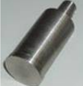
Рисунок 2. Свинцовый поршень для системы смятия патрона \Phi 22
